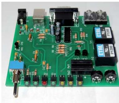
**Bild 4: Die bestückte Platine**
